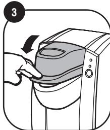
Baje el agarradero completamente y con firmeza, de este modo cerrará la tapa y perforará la unidad de monodosis K-Cup®
