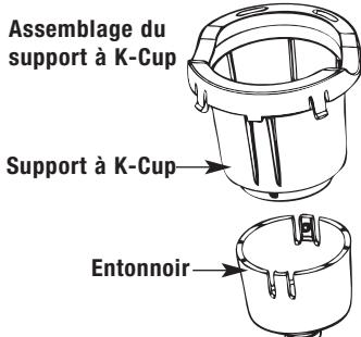
ouvrez la cafetière en appuyant sur le bouton. Saisissez le dessus du support à K-Cup<sup>MC</sup> d'une main et poussez vers le haut sur le fond du support à K-Cup<sup>MC</sup> de l'autre main jusqu'à ce qu'il se libère. Après le nettoyage, enlignez le support à K-Cup<sup>MC</sup> avec l'ouverture en vous guidant sur les deux entailles à l'avant et enclenchez-le en place.
