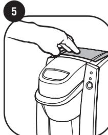
Llene el tanque de agua caliente con agua del regadero o de 1 botella hasta el indicador de NIVEL LLENO.
